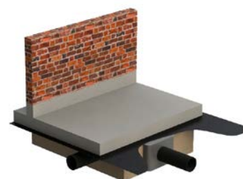
DAFA radonbrønd i et kapillarbrydende lag.
